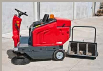
GEMMA E78 nella versione a batteria, ottiene la trazione tramite un elettro motoruota con motore verticale da 900 W, che gli permette di effettuare inversione ad U in soli 2 metri, in pratica gira su se stessa, molto indicata nelle logistiche per la pulizia nelle stive di stoccaggio ed in ambienti angusti, oltre che essere a tutti gli effetti capace di pulire su superfici libere 9.500 mq/h (dato teorico).
