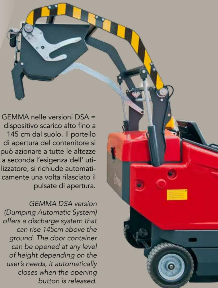
GEMMA nelle versioni DSA = dispositivo scarico alto fino a 145 cm dal suolo. Il portello di apertura del contenitore si può azionare a tutte le altezze a seconda l'esigenza dell' utilizzatore, si richiude automaticamente una volta rilasciato il pulsante di apertura.
