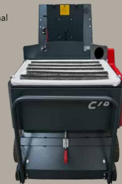
La superficie filtrante è ampia e varia da 5,5 mq per filtro a sacche in tessuto agulgiato di diverse tipologie e da 6,4 mq per filtri a cartuccia in poliestere (n° 8 filtri). Sono infatti due le configurazioni di filtro possibili a seconda delle esigenze e/o delle preferenze. La pulizia del filtro viene sempre ottenuta tramite un vibratore elettrico in entrambe le configurazioni.
