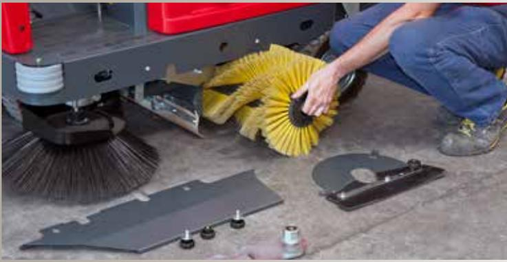
Le spazzole son tutte azionate tramite semplici ed ergonomici leverismi, e si possono sostituire senza l'ausilio di attrezzi.
